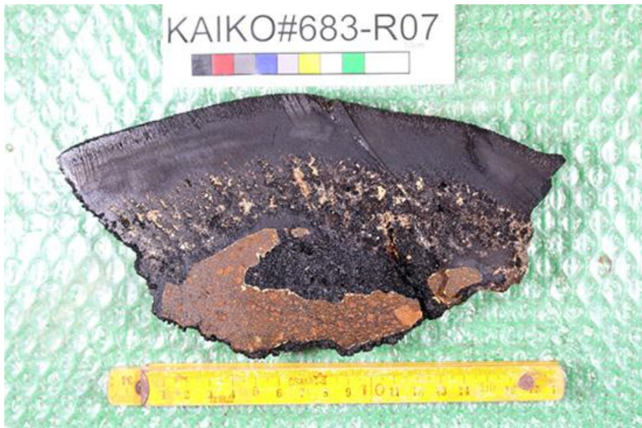
図6 水深 5500m から採掘されたコバルトリッチクラストの一部 (写真: JAMSTEC)
