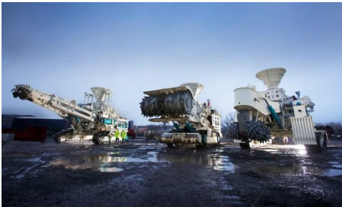
図 18 Nautilus Minerals 社開発の深海採掘用重機。水圧に耐えて稼動するために通常のものより重厚な機材になる (写真:Nautilus Minerals 社)
