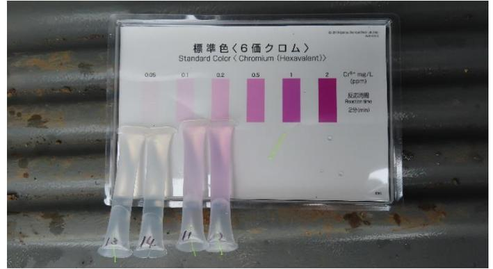
六価クロム簡易検知管による検査結果。右から順にラウエウ川上流(0.15 mg/L)、ラウエウ川下流(マタノ湖近く。0.1 mg/L)の検体(ヌハ郡／2023年7月)
