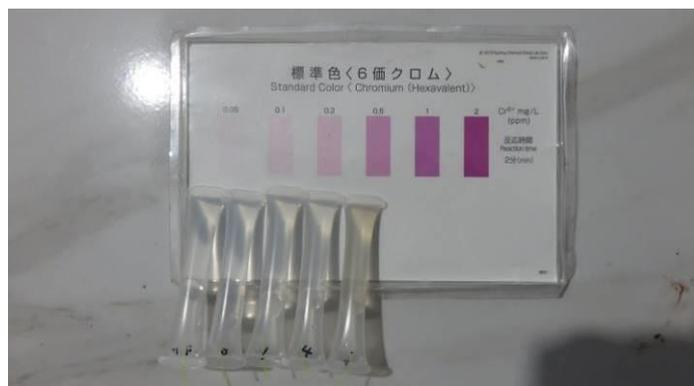
六価クロム簡易検知管による検査結果。一番右が家庭用水として利用していた湧水の検体（トウティ郡／
